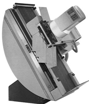
**Рис. 2. Усилитель рентгеновского изображения серии УРИ-612 в составе рентгеновского аппарата**
