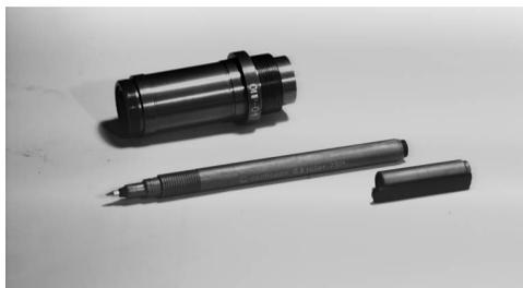
**Рис. 4. Объектив ОПР-1 переноса изображения с рентгеновского преобразователя на телевизионную камеру**
